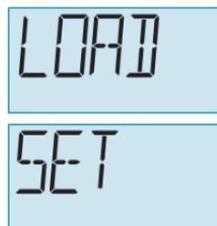
Figure 3-2 Alarme LOAD SET (chargement de la trousse)
