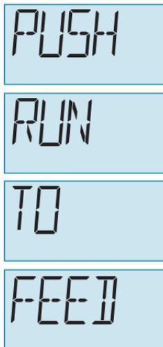
Figure 3-7 Alarme PUSH RUN TO FEED (appuyez sur mise en marche pour commencer une alimentation)
