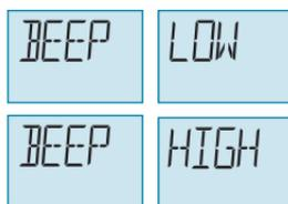
*Figure 2-27 Réglages du volume de l'alarme BEEP LOW (sonnerie faible) et BEEP HIGH (sonnerie forte)*
